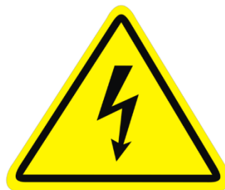
Figura 11 - Pictograma de Perigo para Risco Elétrico
